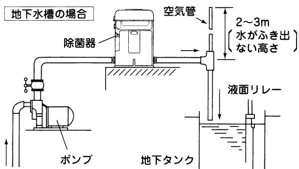
吐出側にサイフォン作用が働くと、ポンプを運転させなくとも、負圧により薬液が注入されてしまいます。
