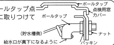
②オーバーフロー管はボールタップ点検用窓を外し確実に取りつけてください。
