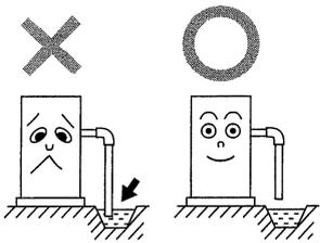
⑨一次給水管には必ずバルブを取りつけてください。二次給水管には排水管を設け、バルブを取りつけてください。
