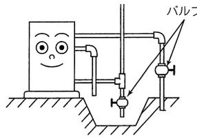
⑩膨張水逃し弁、安全弁からのいっ水管は加圧シスターンのカバーの安全弁いっ水返し口用キャップにナイフ等で穴をあけパイプ等で穴をあけパイプを挿入してください。(いっ水の横引きは先下りにしてください。)
