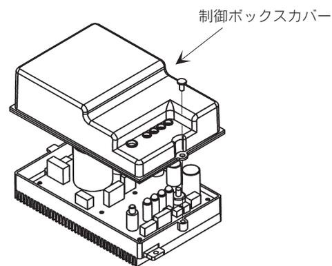
①制御ボックスカバーを外します。
