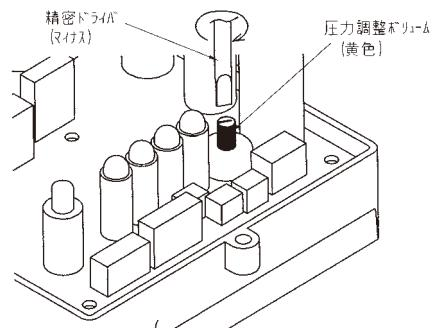
①制御ボックスカバーを外します。
