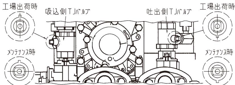
T Jバルブを「メンテナンス時」状態に切替えますと、水は右図のようにバイパスを通ります。従って、メンテナンス時（圧力スイッチ以外）でも水道圧力にて給水できます。
