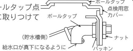
②オーバーフロー管はボールタップ点検用窓を外し確実に取りつけてください。
