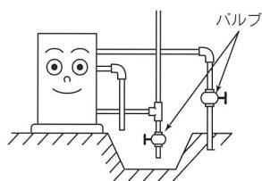
⑩膨張水逃し弁、安全弁からのいっ水管は加圧シスタンのカバーの安全弁いっ水返し口用キャップにナイフ等で穴を開けパイプ等で穴を開けパイプを挿入してください。
