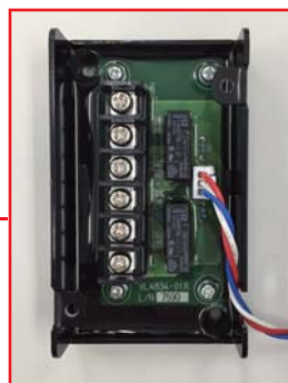
外部出力基板
