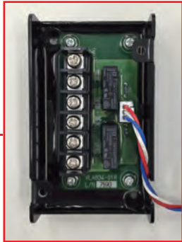
外部出力基板
